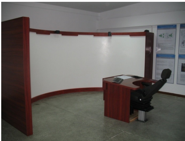
Fig. 3. Large-size screen of the HOMAR OPA simulator Rys. 3. Wieloformatowy ekran symulatora HOMAR OPA
