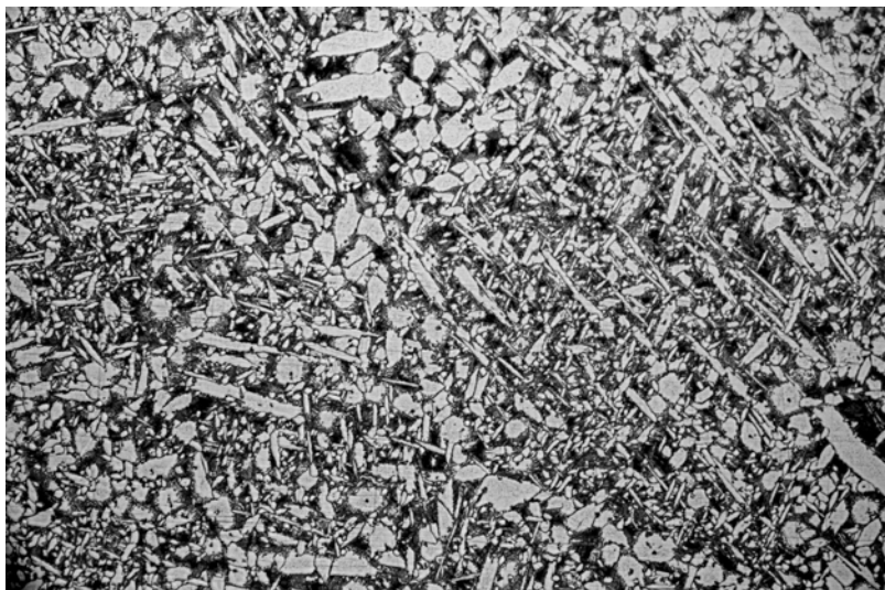
Rys. 2. Mikrostruktura odlewu z brązu BA1055; jasne ziarna fazy \alpha , ciemne tło eutektoidu \alpha + \gamma_2 , faza \kappa słabo widoczna; pow. 200x
