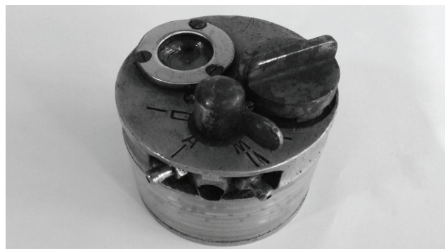
Rys. 4. Desorbometr izobaryczny do długoczasowych pomiarów desorpcji
