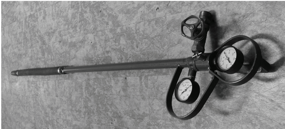
Rys. 3. Sonda pomiarowa do mierzenia ciśnienia gazu używana na kopalni Paskov, rejon Staříč Fig. 3. Probe used for taking measurements of pressure of gas used in Paskov coal mine, Staříč field
