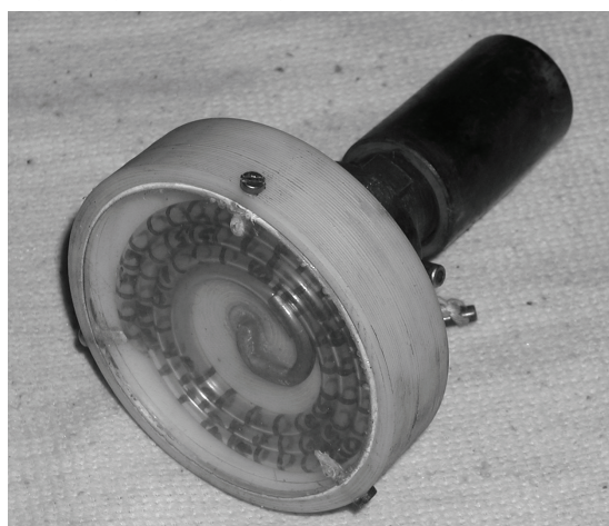
Rys. 2. Desorbometr izobaryczny używany na kopalni Paskov, rejon Staříč
