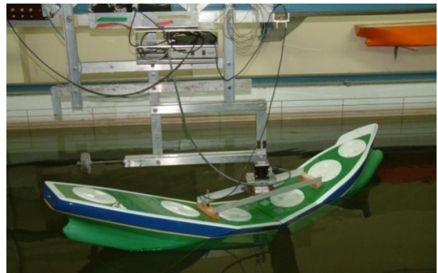
Fig. 6. Model in condition 3 tested in the towing tank Rys. 6. Model dla stanu 3, testowany na holującym tankowcu
