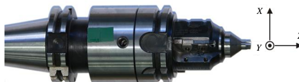
Rys. 1. Widok narzędzia użytego do obróbki gniazd zaworowych
