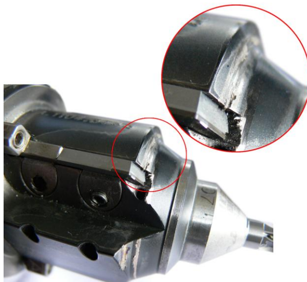
Rys. 3. Widok uszkodzeń oprawki narzędzia powstałych w wyniku tarcia o powierzchnię obrabianego gniazda Fig. 3. View of damages of tool holder as a result of tool holder friction against machined valve seat
