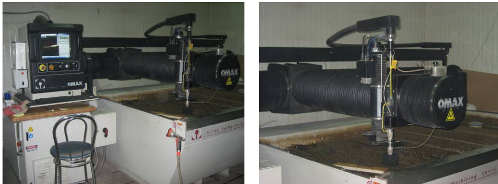
Rys. 7. Centrum obróbki OMAX 55100 — przygotowanie do wycinania próbek
