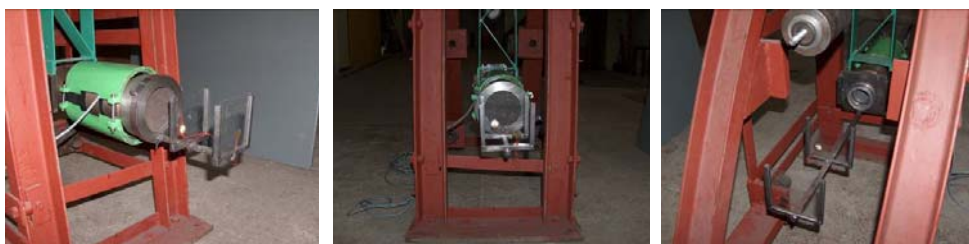
Rys. 10. Widok wahadła z zamontowaną próbką
