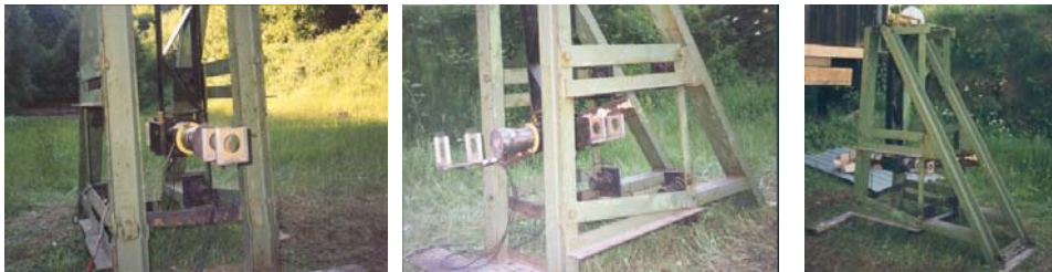
Rys. 2. Stanowisko do badania odporności balistycznej materiałów przed modernizacją
