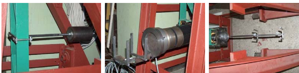
Rys. 4. Widok elementów stanowiska: przeciwwaga, tuleja, ramki pomiarowe
