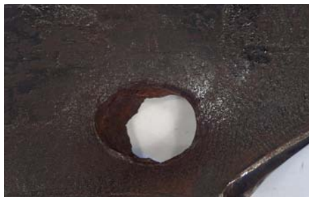
Rys. 4. Obraz perforacji materiału tarczy ze stali 10GHMBA pociskiem kal. 12.7 mm
