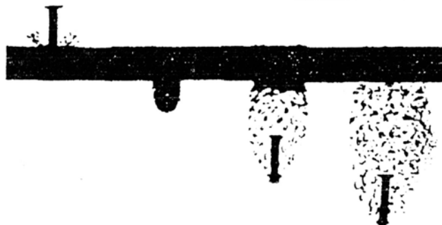
Rys. 1. Etapy procesu balistycznej perforacji tarczy stalowej przez stalowy pocisk ( L/D = 10 ) o szybkości uderzenia V_{pk} = 2500 m/s (przypomina mechanizm oddziaływania strumienia) [15]
