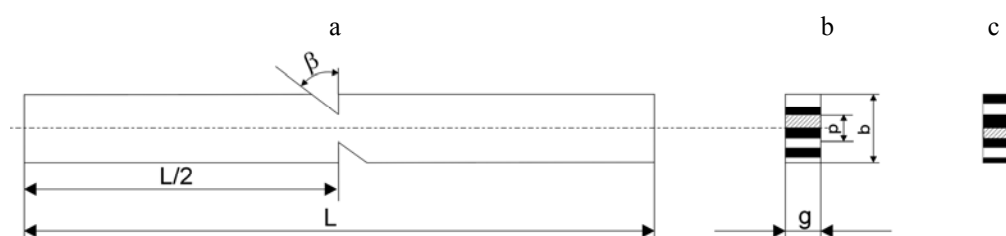
Rys. 3.: a) zmodyfikowana próbka Iosipescu; b) próbka o warstwach wierzchnich drewna późnego; c) próbka o warstwach wierzchnich drewna wczesnego ( \beta = 45^\circ , g = 5 mm — grubość próbki, b = 20 mm — szerokość próbki, p = 5 mm — długość przekroju pomiarowego, L = 80 mm — długość próbki)
