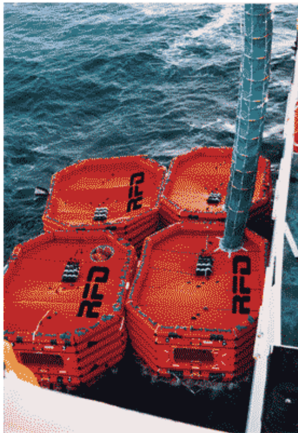
Rys. 5. Masowy system ewakuacji RFD
