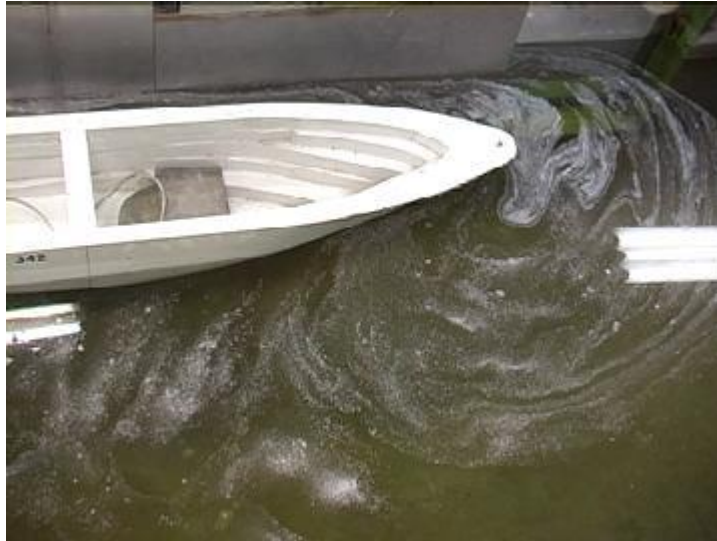
Rys. 4. Obraz opływu modelu statku podczas cumowania Fig. 4. Flow pattern around the ship model during berthing
