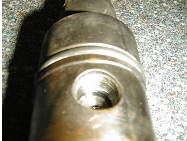
Rys. 1. Widok korpusu wtryskiwacza silnika okrętowego typu Sulzer 6AL20/24D z uszkodzonym gwintem wewnętrznym
