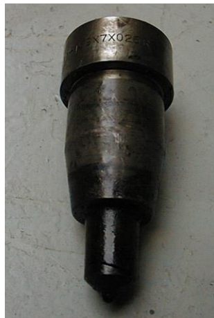
Rys. 2. Przykład rozpylacza pokrytego nagarem
