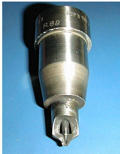
Rys. 3. Widok rozpylacza poddanego odnowie z odłamanym fragmentem korpusu Fig. 3. A view of reconditioned injector nozzle with a broken part of the body
