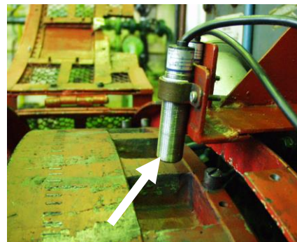
Rys. 9. Pomiar prędkości obrotowej wału korbowego silnika Fig. 9. Place of fixing the inductive gauge for crankshaft rpm
