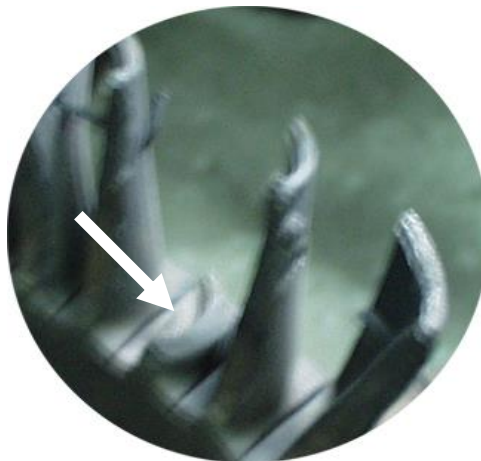
Rys. 2. Pęknięcie zmęczeniowe łopatki wirnikowej turbosprężarki Fig. 2. Fatigue crack of the turbocharger rotor blade
