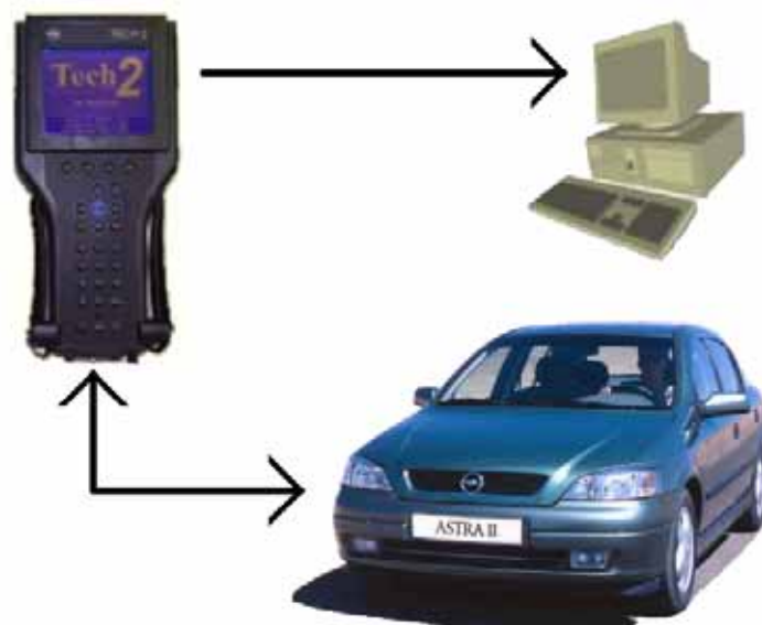
Rys. 3. Transmisja diagnostyczna w samochodach Opel
