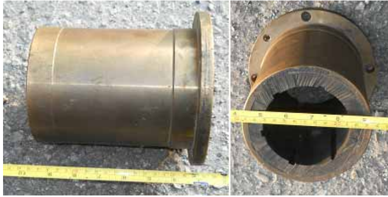
Rys. 4. Zregenerowana tuleja ślizgowa.
