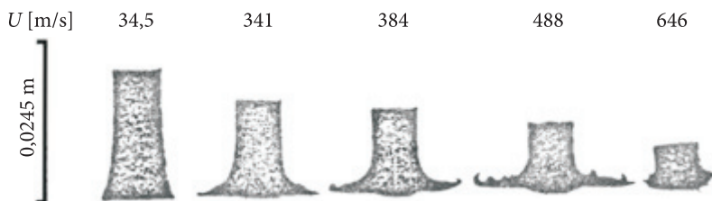
Rys. 3. Cylindry stalowe po uderzeniu [2]
