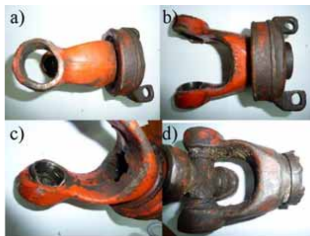
Rys. 3. Typowe uszkodzenia wałów z przegubami Cardana: a), b) zniszczenie widłaka, c) pęknięcie elementów łożyska łącznika krzyżowego, d) skrzywienie rury łączącej przegub
