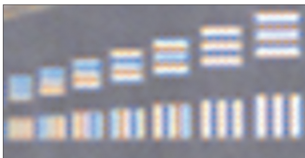
Rys. 1. Zobrazowanie celu kalibracyjnego w Wright Patterson Airforce Base wykonane za pomocą cyfrowego sensora lotniczego RCD105
