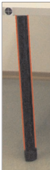
Rys. 6. Sposób wyznaczania linii bocznych przekroju walca
