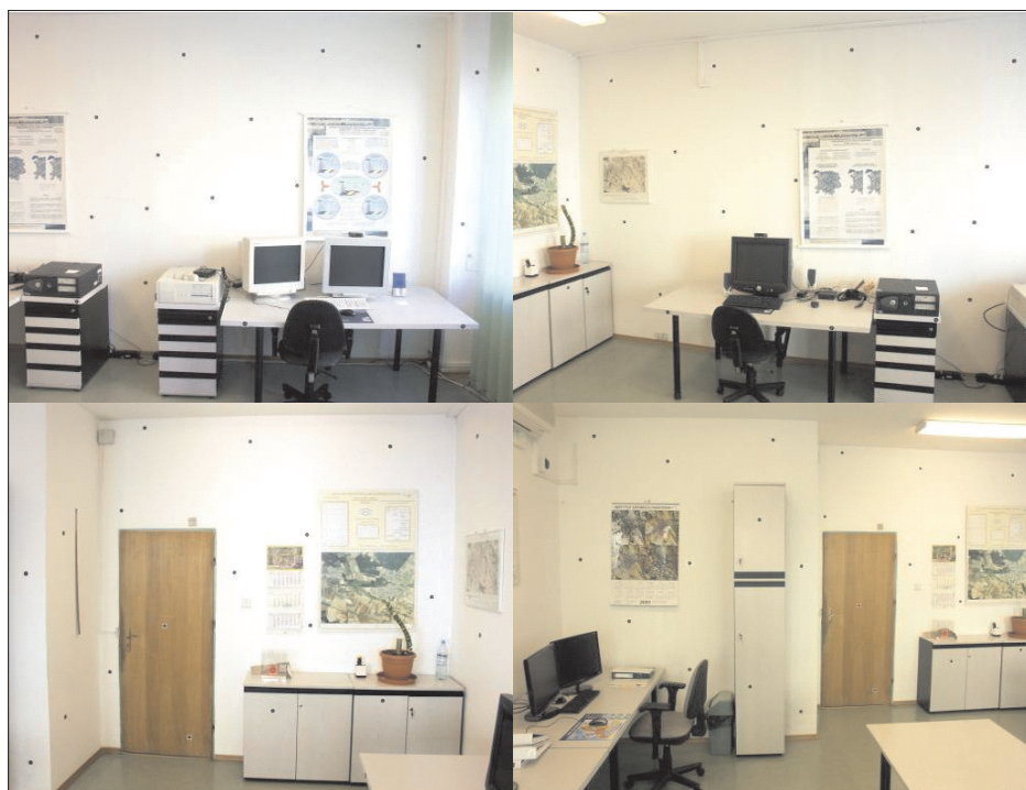
Rys. 4. Rozmieszczenie punktów osnowy pomiarowej w pomieszczeniu testowym
