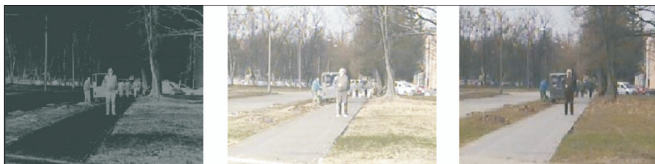
Rys. 8. Końcowy rezultat działania algorytmu syntezy obrazów. Na rysunku obrazy: z kamery termowizyjnej (po lewej), z kamery VIS (po prawej), wynikowy obraz po syntezie (w środku)
