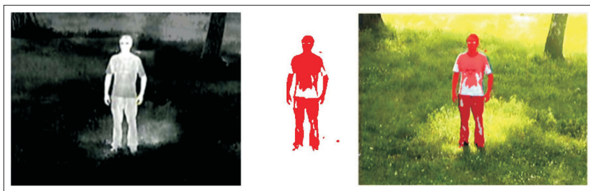
Rys. 7. Koncepcja syntezy obrazów: termogram (po lewej), maska dla ustalonego progu temperaturowego (w środku) oraz efekt nałożenia maski na obraz z kamery VIS (po prawej)
