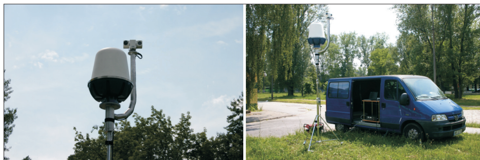
Rys. 2. Widok wieloczułnikowej platformy obserwacyjnej: kopuła radaru (na dole) oraz ruchomy zespół kamer (w części górnej)
