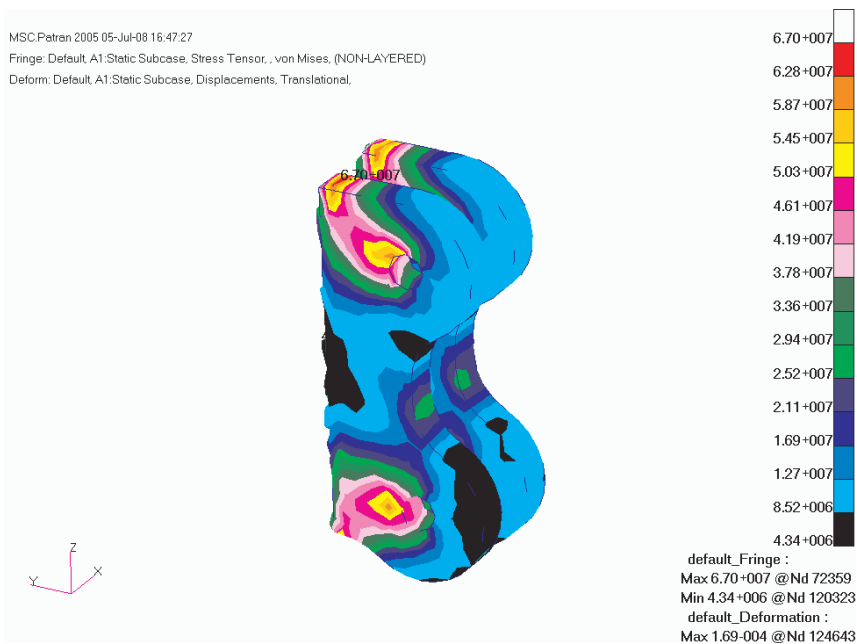
Rys. 34. Naprężenia zredukowane w węźle mocowania na wrzędze nr 6 [Pa]
