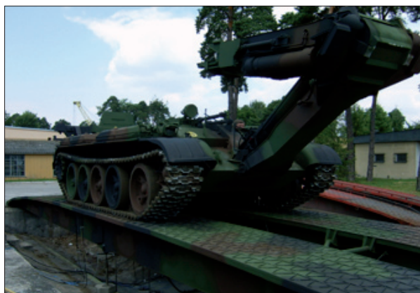
Rys. 9. Gąsienicowe podwozie nośne BLG bez transportowanego przęsła podczas próby obciążeniowej w wariantcie I
