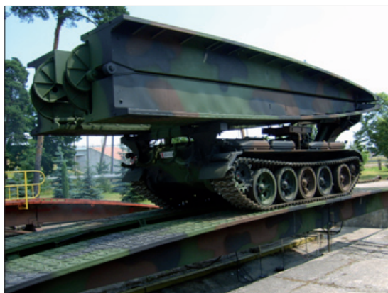
Rys. 12. Zestaw gaśnicowego podwozia nośnego BLG z transportowanym przęsłem mostu podczas próby obciążeniowej w wariantcie II
