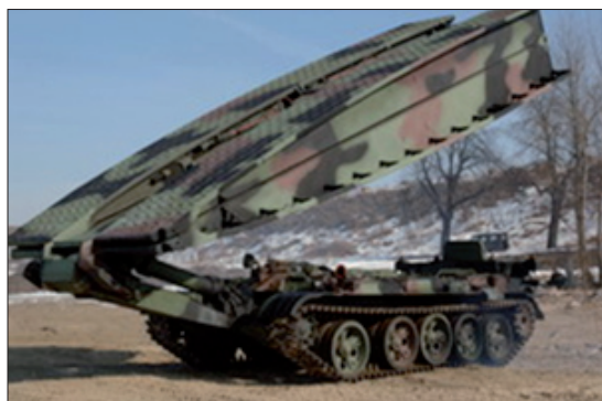
Rys. 1. Widok ogólny przęsła mostu BLG-67M na podwoziu gąsienicowym
