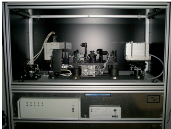
Rys. 4. Sterowany komputerowo wzorec jednostki mocy średniej i energii promieniowania laserowego
