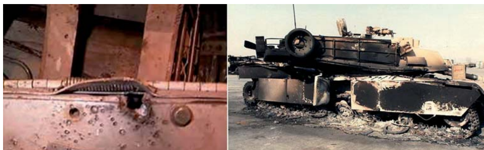
Rys. 3.7. Postać zniszczeń płyt pancernych przez pociski przeciwpancerne
