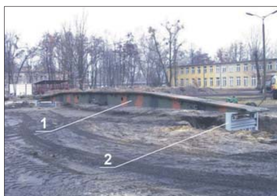
Rys. 10. Widok prototypu kolejiny mostu MS-20 podczas przygotowywania stanowiska badawczego do wykonania próby niszczącej: 1 — blok kolejinowy; 2 — podpory hydrauliczne
