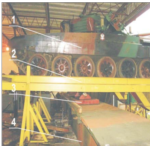
Rys. 5. Widok ogólny stanowiska badawczego podczas prowadzenia badań: 1 — pojazd obciążający (czołg PT-91); 2 — pomost obciążający; 3 — płyta przekazująca obciążenie; 4 — przęsło (koleina mostu)
