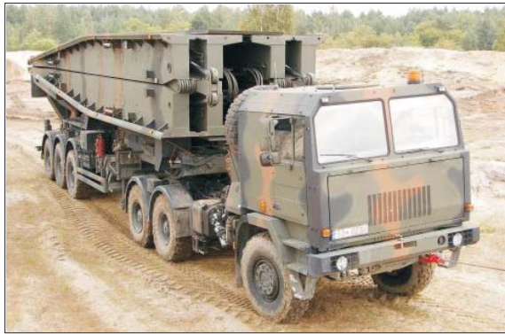
Rys. 1. Prototyp mostu samochodowego MS-20 [6]
