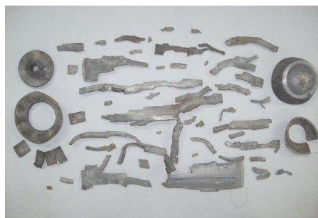
Rys. 2.3. Odłamki odzyskane po detonacji ANFO \alpha
