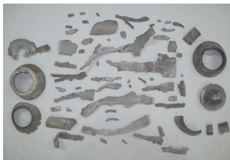
Rys. 2.4. Odłamki odzyskane po detonacji amonalu \beta
