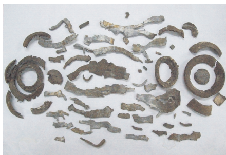
Rys. 4.3. Odłamki odzyskane po próbie z amonalem \alpha
