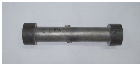
Rys. 4.11. Odłamki odzyskane po próbie z piaskiem
