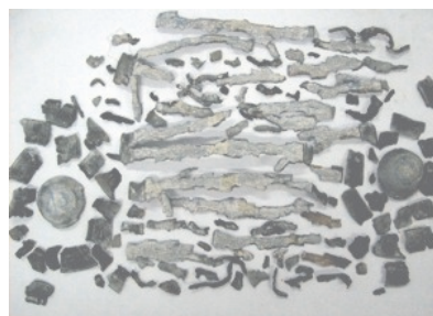
Rys. 4.10. Odłamki odzyskane po próbie z prasowanym TNT
