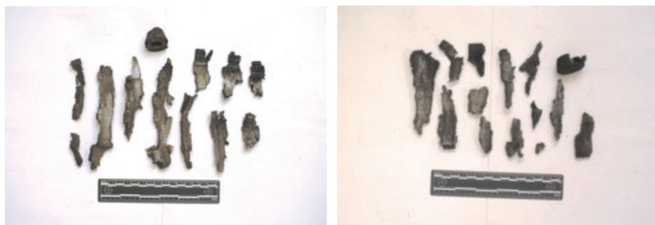
Rys. 5.3. Odłamki odzyskane po próbach z pociskami odłamkowymi
