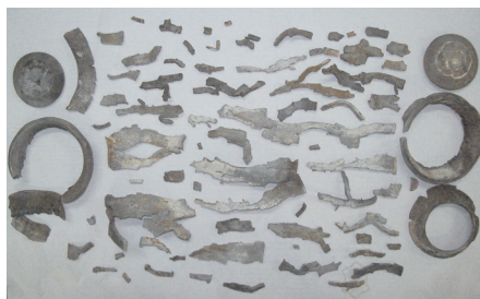
Rys. 4.5. Odłamki odzyskane po próbie z MWE
