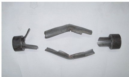
Rys. 4.2. Odłamki odzyskane po próbie z ANFO \beta
