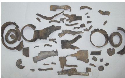
Rys. 4.8. Odłamki odzyskane po próbie z sytkim TNT
