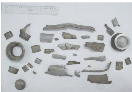
Rys. 4.4. Odłamki odzyskane po próbie z amonalem \beta
