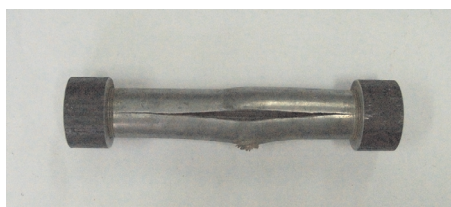
Rys. 4.12. Odłamki odzyskane po próbie z wodą
