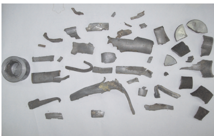
Rys. 4.6. Odłamki odzyskane po próbie z MWE + RDX
