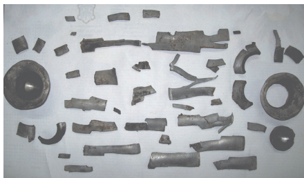
Rys. 4.1. Odłamki odzyskane po próbie z ANFO \alpha
