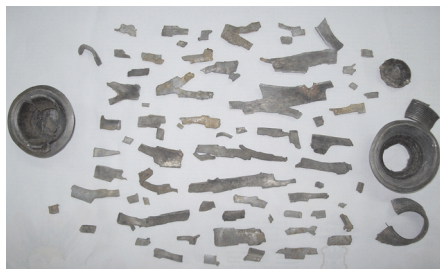
Rys. 4.7. Odłamki odzyskane po próbie z TNT + proch
