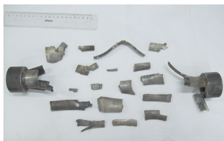
Rys. 4.9. Odłamki odzyskane po próbie z odlewanym TNT
