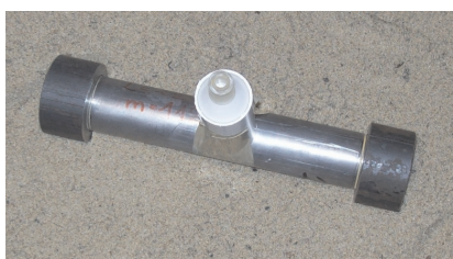
Rys. 2.1. Stalowa rura z ładunkiem materiału wybuchowego i ładunkiem kumulacyjnym
