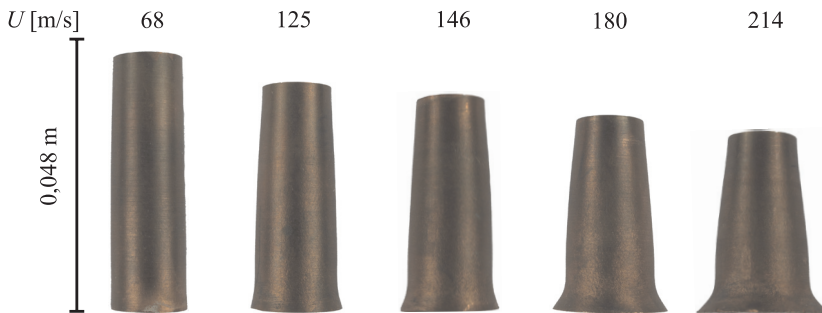
Rys. 3. Kształty cylindrów odkształconych plastycznie po testach Taylora. Początkowe wymiary cylindrów jednakowe: długość L = 0,048 m, średnica D_0 = 0,012 m
