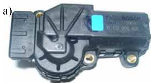
Rys. 1. Silniki skokowe: a) regulujący wtrysk silnika spalinowego, b) regulujący obroty biegu jałowego Źródło: http://zme.iee.put.poznan.pl/Lab/labAiR/lab12_teoria.pdf .
