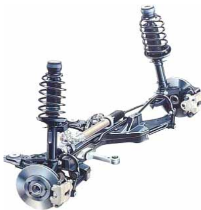
Rys. 1. Zawieszenie z kolumnami prowadzącymi samochodu VW Golf IV
