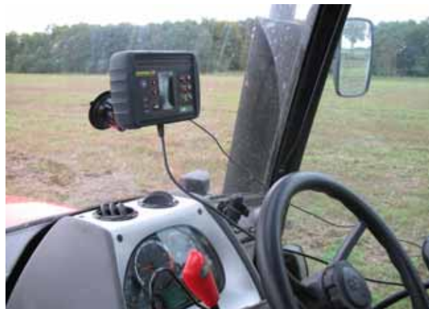
Rys. 2. Odbiornik Centerline 220 zamocowany na szybie ciągnika
