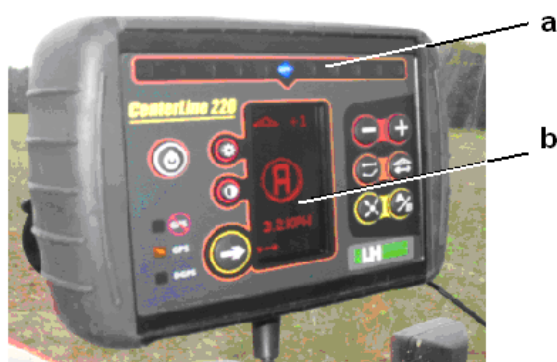
Rys. 4. Widok odbiornika Centerline 220: a – panel z diodami, b – ekran odbiornika Źródło: Badania własne.
