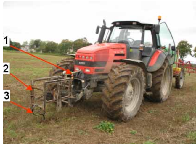
Rys. 1. Ciągnik Same Iron 200 ze znacznikiem: 1 – podnośnik hydrauliczny, 2 – rama znacznika, 3 – ząb sprężynowy
