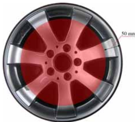
Rys. 3. Obręcz koła z zaznaczonym czerwonym polem, w obrębie którego naprawa jest zabroniona
