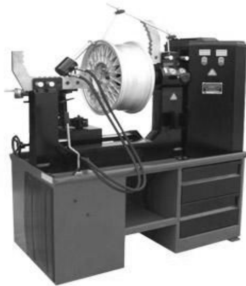
Rys. 2. Maszyna do prostowania obręczy kół samochodowych
