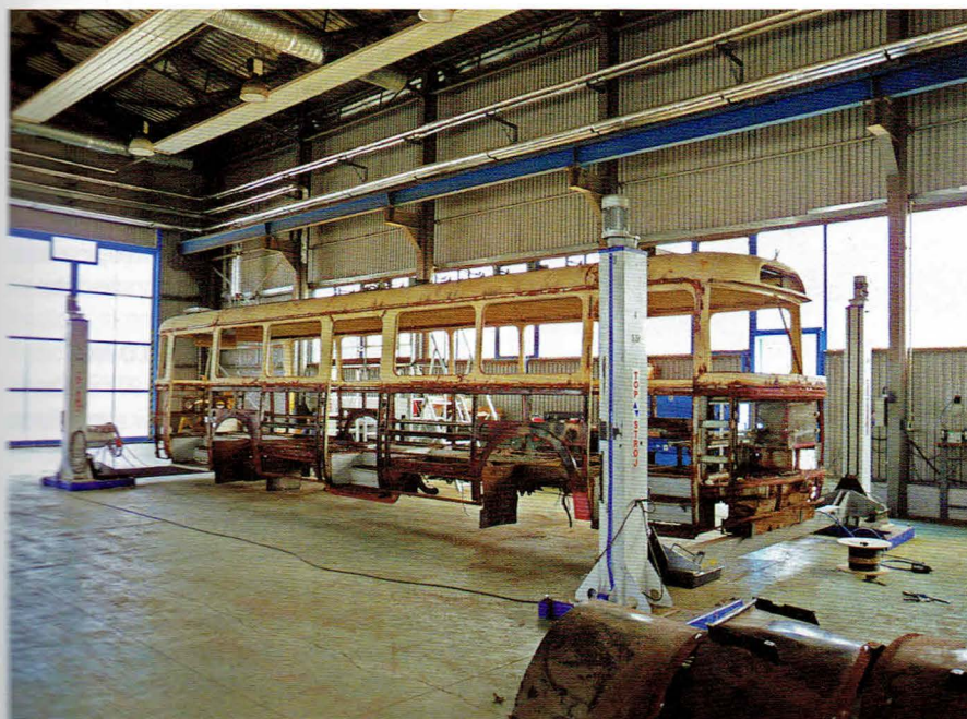
Stan konstrukcji po zakończeniu demontażu Škody
