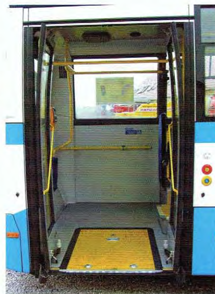
Mimo użycia typowego podwozia samochodu dostawczego, na tylnym zwisie Wetliny City wypracowano przestrzeń z niską podłogą
