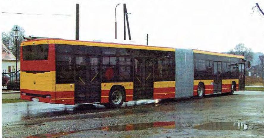
Cztero dwuskrzydłowych drzwi znacznie przyspiesza wymianę pasażerów na przystankach
