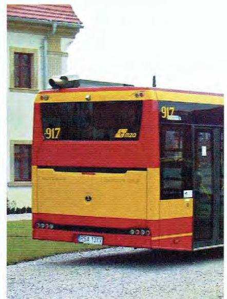
Rura wydechowa w Sancity 12LF została wprowadzona ponad linię dachu
