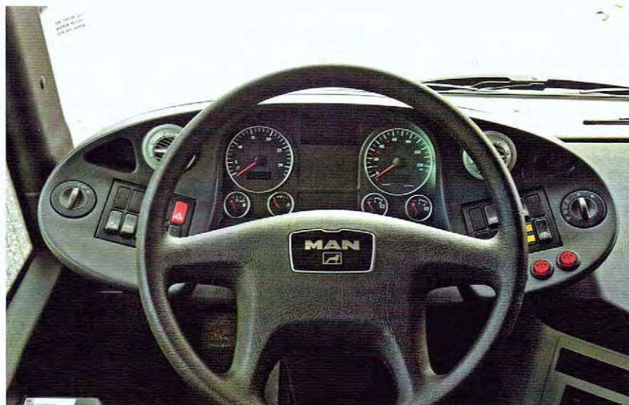
Na desce rozdzielczej wprowadzono kilka dodatkowych liczników informujących m.in. wskaźnik naładowania kondensatorów
