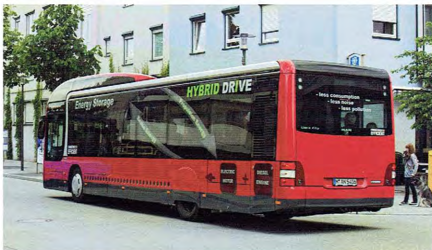
Zmniejszenie oporów aerodynamicznych osiągnięto także dzięki wprowadzeniu osłon na koła tylne
