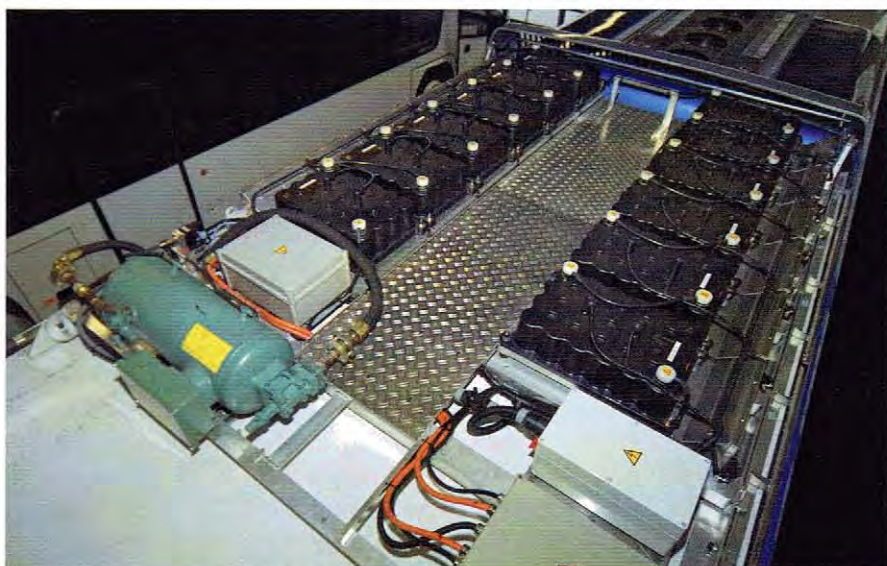
W nowym autobusie hybrydowym MAN energię odzyskiwaną podczas hamowania przetrzymuje się w jednym z 12 kondensatorów energii
