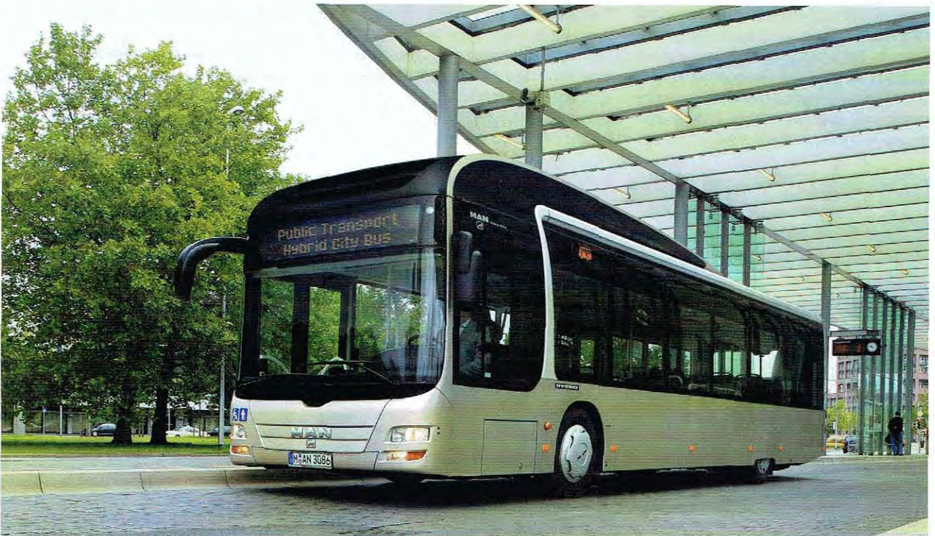
W nowym Lion's City Hybrid obniżenie zużycia paliwa osiągnięto poprzez optymalizację kształtu nadwozia
