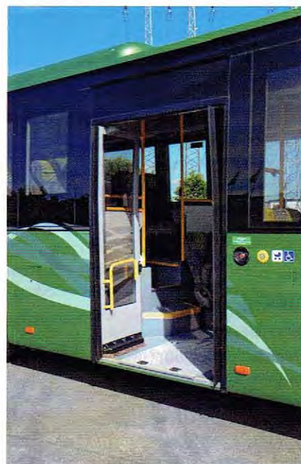
Środkowe dwuskrzydłowe drzwi z rampą dla wózków inwalidzkich
