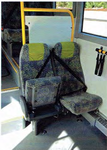
Przestrzeń naprzeciwko środkowych drzwi z zamontowanymi stramponetami, wyposażonymi w trójpunktowe pasy bezpieczeństwa
