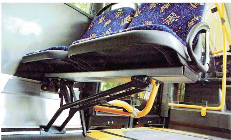
Zabudowa foteli „canti-lever” znacznie ułatwia sprzątanie pojazdu
