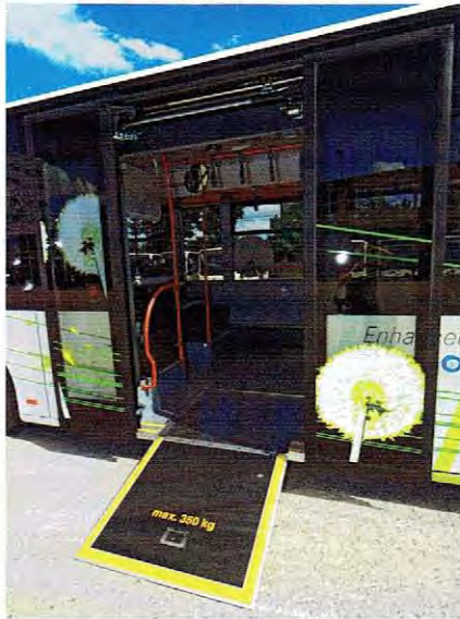
Standardowym wyposażeniem każdego autobusu jest ręcznie otwierana rampa o nośności 350 kg
