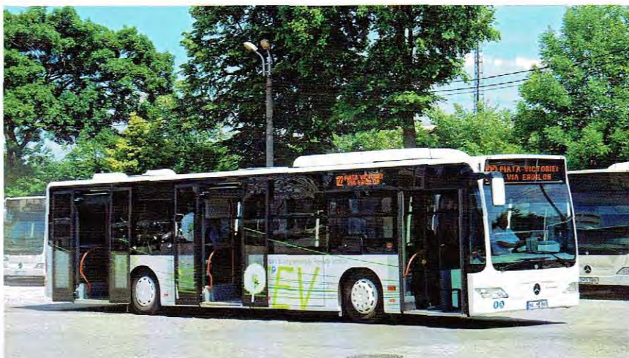
W Mercedesie Citaro zaprezentowano wersję z drzwiami odskokowo-przesuwными, zapewniającymi szybszą wymianę pasażerów, dzięki większej szerokości czynnej drzwi
