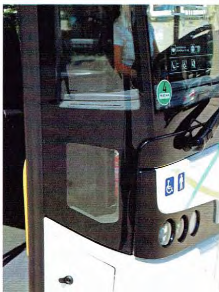
Dodatkowe okienko w prawym narożniku, umożliwiające precyzyjny podjazd pod przystanek w VDL Citea
