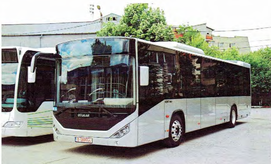
Poszycie obłachowania bocznego podzielone na segmenty tak, aby obniżyć koszty ewentualnych napraw powypadkowych
