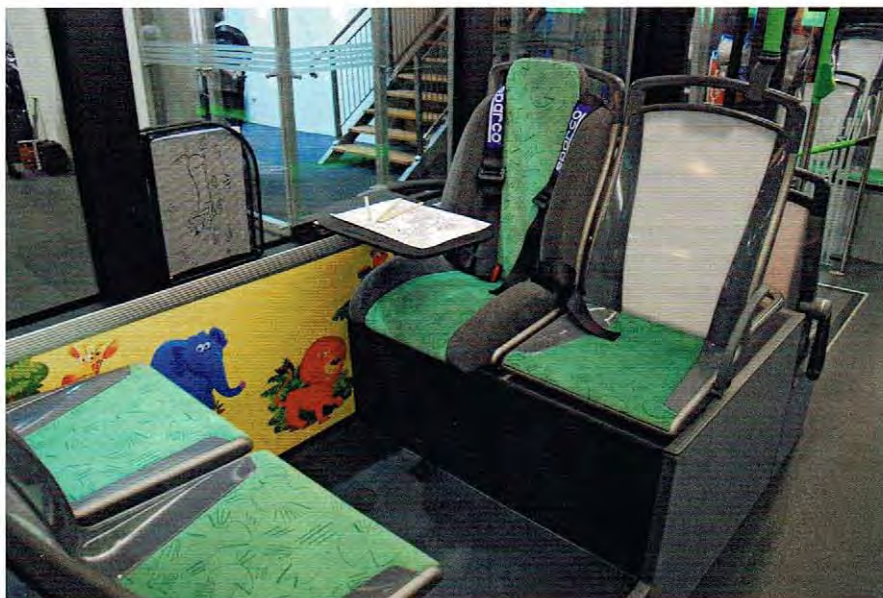
We wnętrzu hybrydy zamontowano fotele Ster 6MS z oparciami wykonanymi z tworzywa przepuszczającego światło. Tutaj na podeście ponad bateriami do gromadzenia energii hamowania
