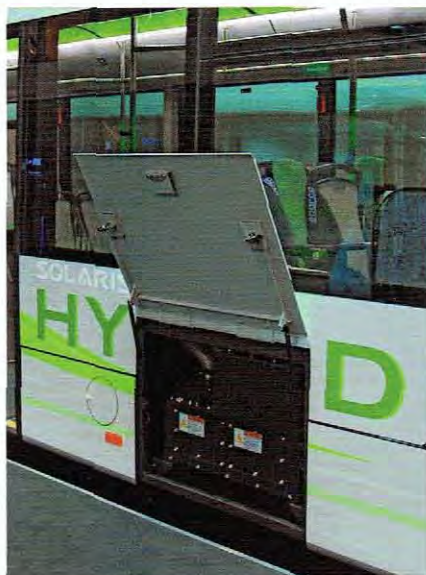
Zestaw baterii umieszczono tuż za prawym przednim nadkolem
