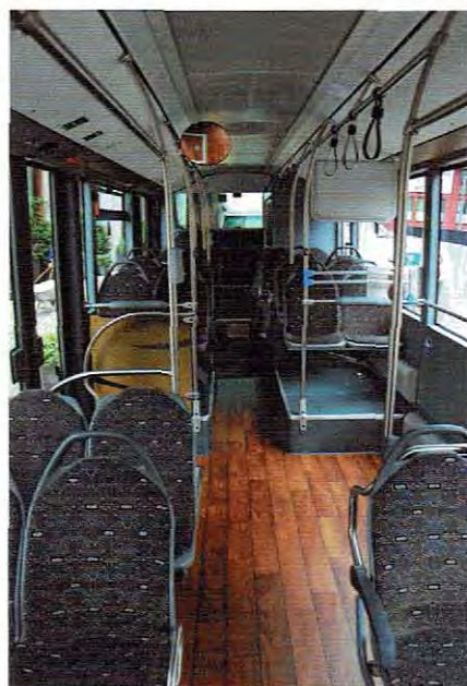
Wnętrze autobusu wodorowego z charakterystyczną panelową podłogą
