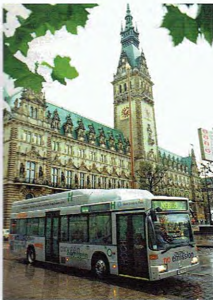
NEBUS – autobus napędzany ogniwami paliwowymi, bazujący na Mercedesie O405N2 (fot. Daimler AG)
