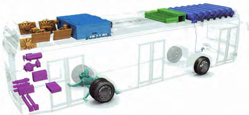
Rozkład komponentów w Citaro Fuel Cell Hybrid (rys. Daimler AG)
