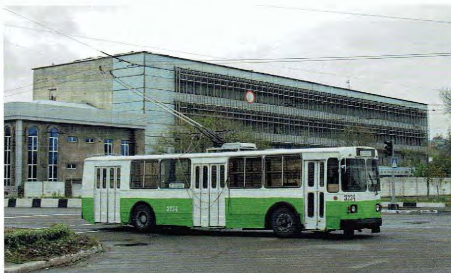
Trolejbus ZIU-682 w wersji dla Uzbekistanu posiadał zwiększoną liczbę otwieranych okien
