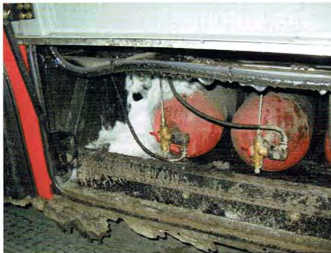
Rys. 9. Osadzający się śnieg na butlach gazowych pod podłogą autobusu [2]
