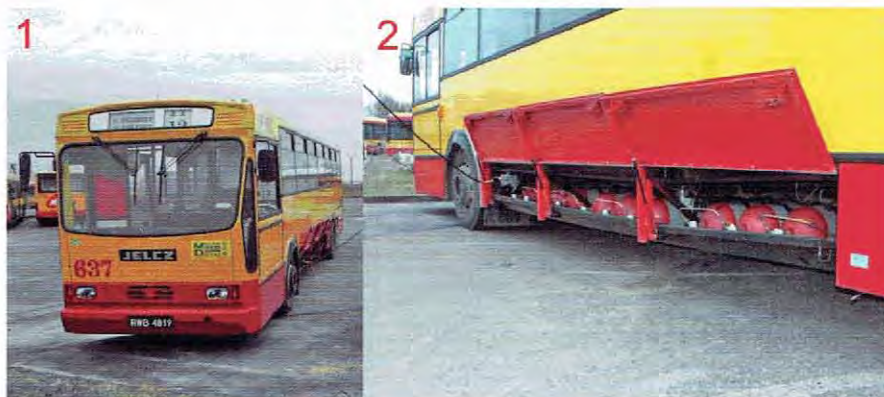
Rys. 1. Autobus Jelcz120 M /1/CNG/ po modernizacji: 1 – widok autobusu, 2 – rozmieszczenie butli pod podłogą [2]
