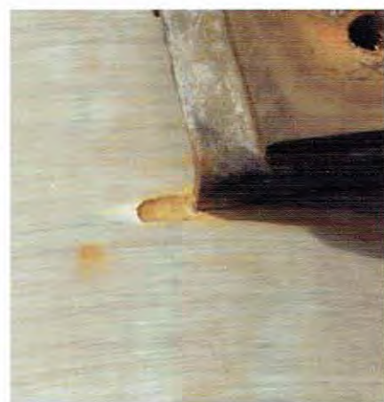
Rys. 8. Uszkodzenie butli w wyniku otarcia [2]
