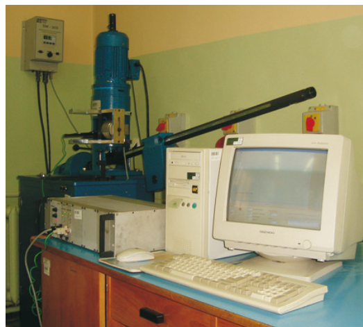
Rys. 6. Stanowisko badawcze do badań właściwości smarnościowych
