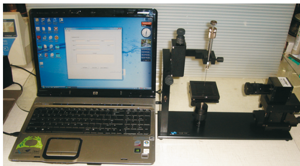
Rys. 3. Stanowisko badawcze do badań statycznego kąta zwilżania
