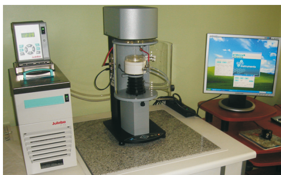
Rys. 2. Stanowisko do badań gęstości, napięcia powierzchniowego i kąta zwilżania
