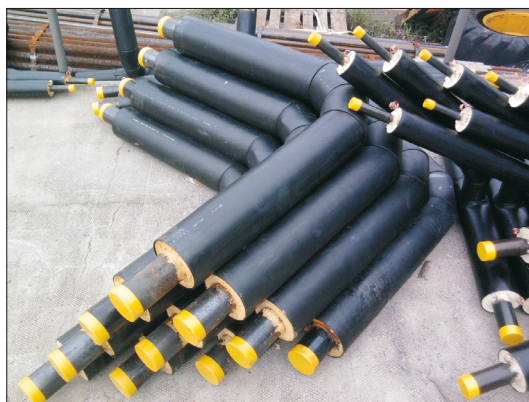
Rys. 7. Ogólny widok gotowych kolan preizolowanych (firma ELZAS-Leszno)
