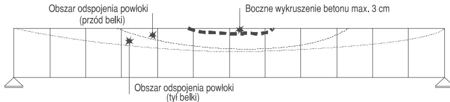
Rys. 10. Schemat mechanizmu zniszczenia belki E13
