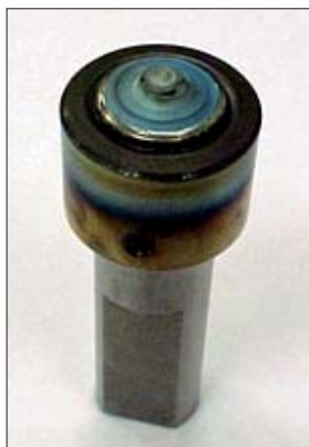
Rys. 3. Typowa konstrukcja trzpienia roboczego stosowanego w FSW [6]
