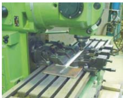
Rys. 2. Stanowisko w IS do realizacji zgrzewania wg metody FSW [6]. Oznaczenia: V_n — prędkość obrotowa; V_{zg} — prędkość liniowa
