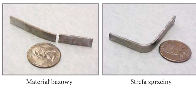
Rys. 10. Praktyczny efekt uplastycznienia materiału w strefie FSP [22]
