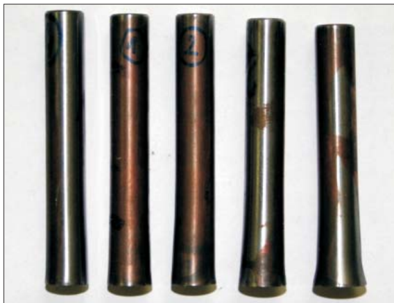
Rys. 3. Widok próbek walcowych po wykonaniu testu Taylora
