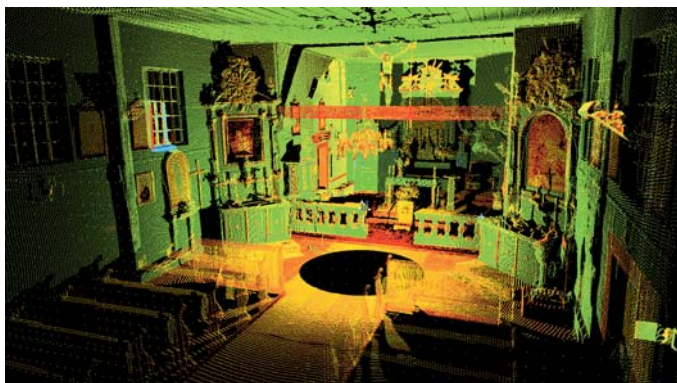
Rys. 4. Wynik skanowania wnętrza kościoła. Krąg na środku to pole pod stanowiskiem skanera
