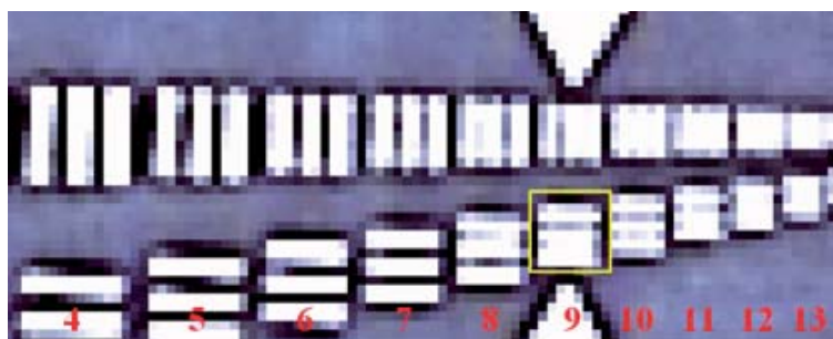
Rys. 9. Fragment zobrażenia celu kalibracyjnego w Wright Patterson AFB z zaznaczonymi numerami poszczególnych grup pasów
