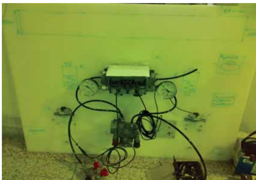
Rys. 3. Stanowisko do badań układ EBS w budowie
