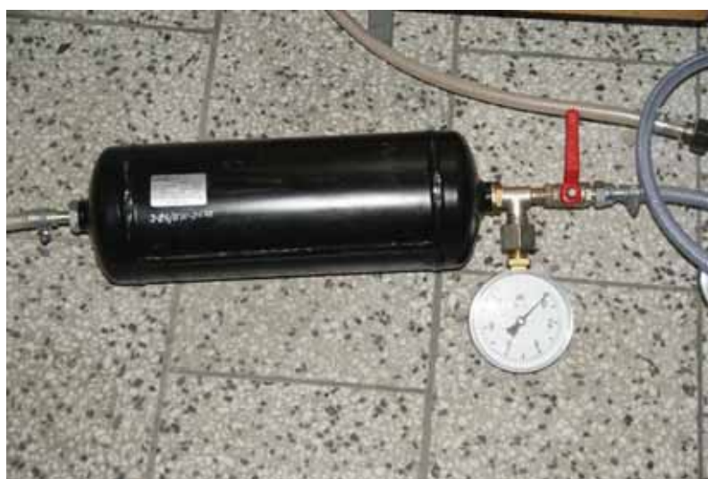
Rys. 6. Zbiornik powietrza wraz z manometrem i zaworem
