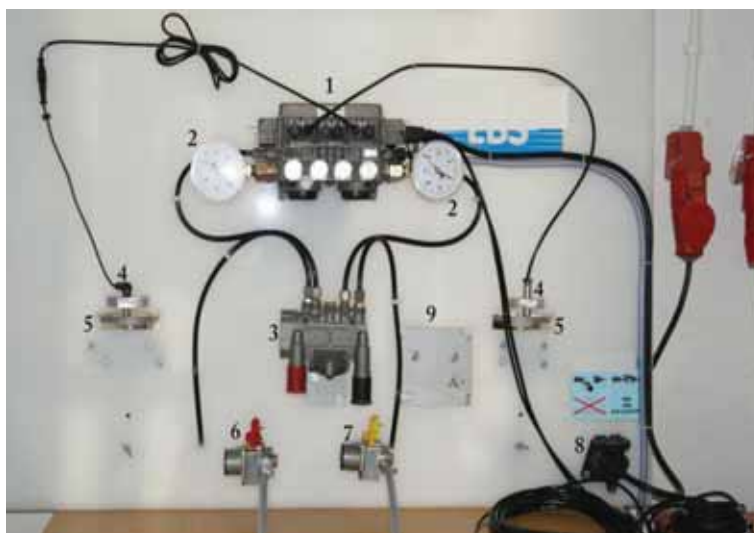
Rys. 8. Opis stanowiska do badań układu EBS w samochodach ciężarowych: 1 - modulator firmy; 2 - mierniki ciśnienia; 3 - zintegrowany zawór luzujący; 4 - czujniki prędkości; 5 - koła wieńcowe; 6 - złącze zasilające; 7 - złącze sterujące; 8 - złącze ISO; 9 - regulator prędkości obrotowych kół wieńcowych
