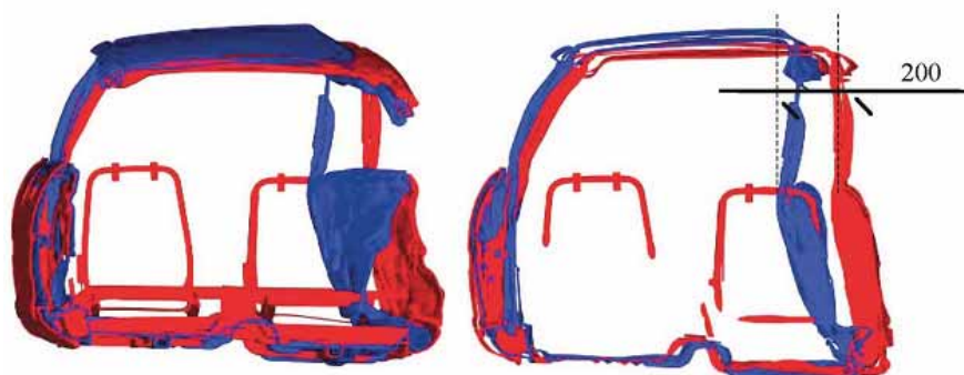
Rys. 8. Wyniki symulacji numerycznych. Kolor niebieski – auto referencyjne, bez dodatkowego wzmocnienia drzwi bocznych. Kolor czerwony – auto wyposażone w opisywany system [25].
