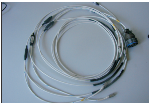
Rys. 3. Przykładowe podzespoły i części składowe szyny MIL-1553B
