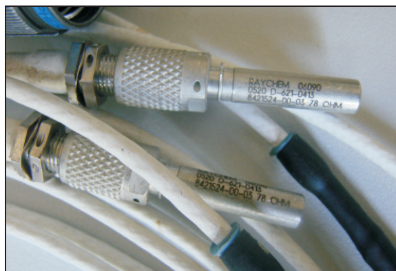
Rys. 5. Przykładowe terminatory „zamykające” szynę MIL-1553B
