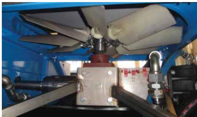
Rys. 6. Widok wentylatora poduszki powietrznej, który zamontowany jest na wałku przekładni kąto- wej. Z lewej strony przekładni widoczny wałek napędowy ze sprzęgłem kłowym
