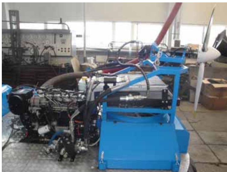
Rys. 4. Widok silnika VM MOTORII - R 756 EUS , obudowy wentylatora poduszki powietrznej z, zamontowaną nad nim, chłodnicą i intercoolerem silnika i wspornikiem obrotnicy silnika hydraulicznego śmigła Poduszkowcowego Nośnika Narzędzi
