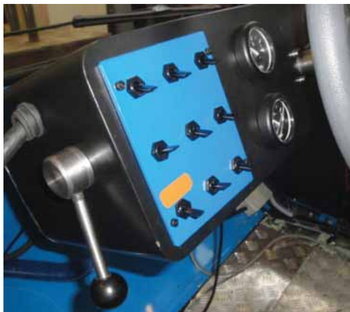
Rys. 3. Widok dźwigni zmiany prędkości obrotowej silnika (800-2100 obr/min)
