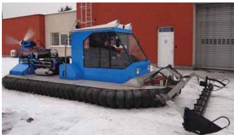
Rys. 7. Widok prototypu badawczego PNN podczas prób na terenie PIMR. Na kabinie widoczny reling, nad nim antena GPS-SPAN, w części dziobowej na adapterze zamontowano kosiarkę czołową
